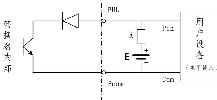
b) 数字量输出接光电耦合器 (如 PLC 等)
