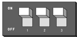
开关 1：ON 为流量标定时脉冲输出 OC 门，接上拉电阻；OFF 为不接。
