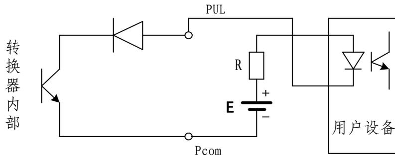
一般，用户光耦需 10mA 左右电流，因此， $E/R=10\text{mA}$  左右。 $E=5\sim 24\text{V}$ 。
