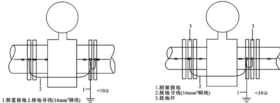
B. 仪表安装在塑料管道或内壁绝缘的管道上时，在传感器的出口和入口要安装接地环，或采用内部接地电极使测量接地与液体接通。
